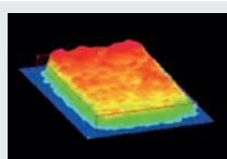
La altura de la cámara se corrige mediante el ajuste automático del enfoque para realizar un seguimiento en cualquier alabeo de PCB de hasta  $\pm 5$  mm.
